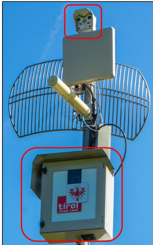
Abbildung 4: Mast mit Bestückung (oben: Webcam alt; Mitte: Antennen; unten: Webcam neu)
